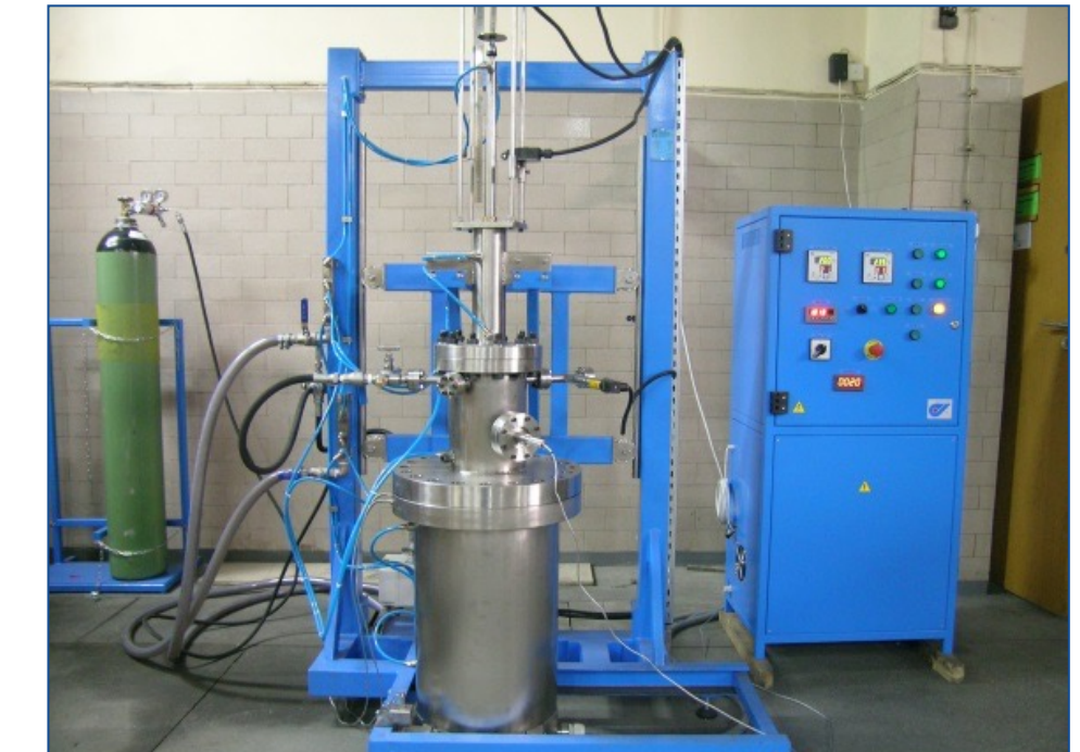
Stanowisko do infiltracji struktur porowatych metodą GPI
