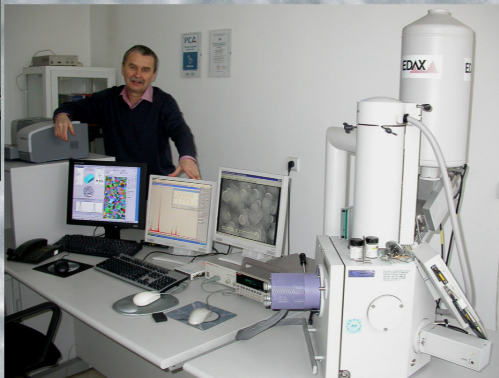
Skaningowy Mikroskop Elektronowy ze zmienną próżnią E-SEM FEI XL30 + system EBSD HKL Technology + EDS EDAX Genesis 4000
